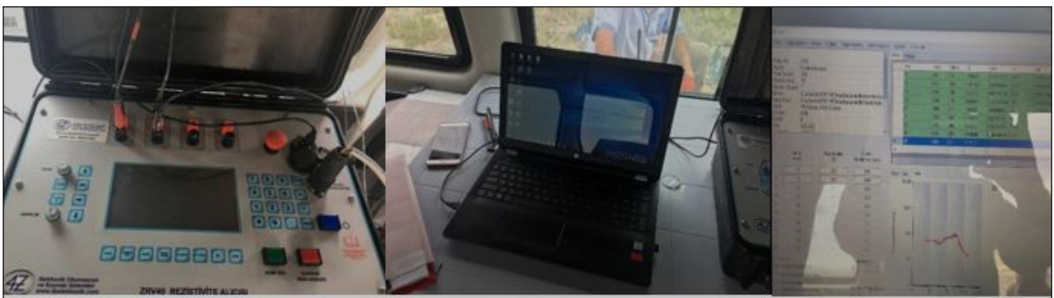
Şekil 5- DES çalışmalarında kullanılan öz direnç donanımı.
