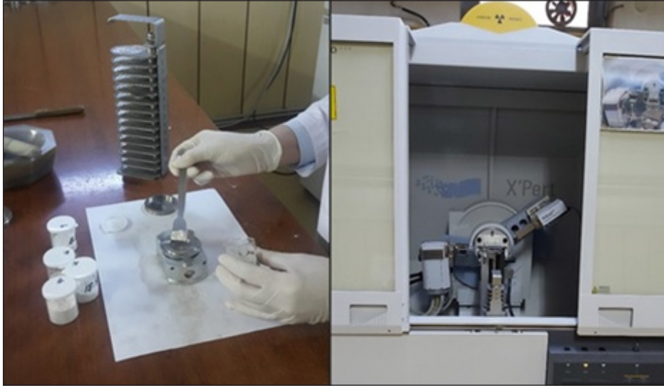
Şekil 4- Numunenin tutucuya yerleştirilmesi ve XRD analizi yapılan Panalytical X'Pert Powder marka model cihaz.
