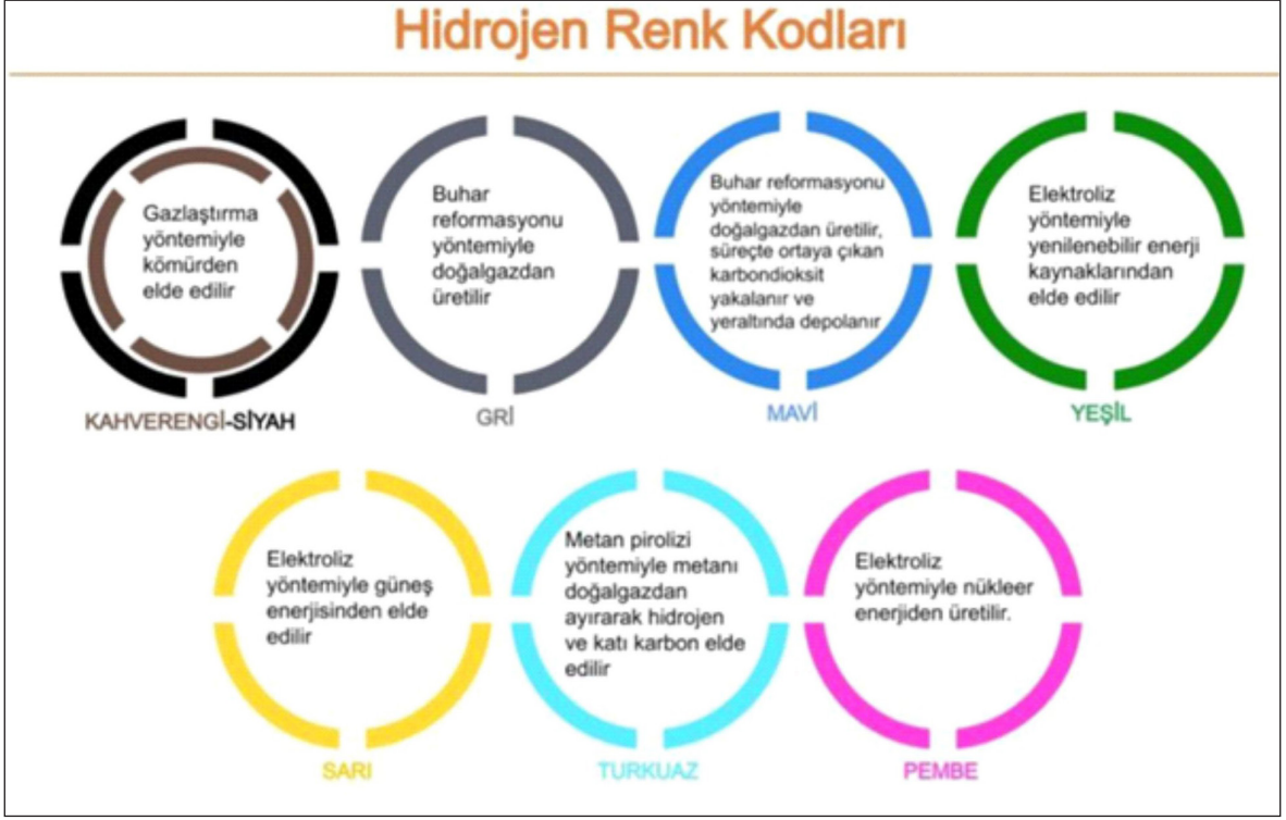
Şekil 2- Hidrojen renk kodları ve elde edildiği kaynak ve yöntemler (www.solar3gw.org).
