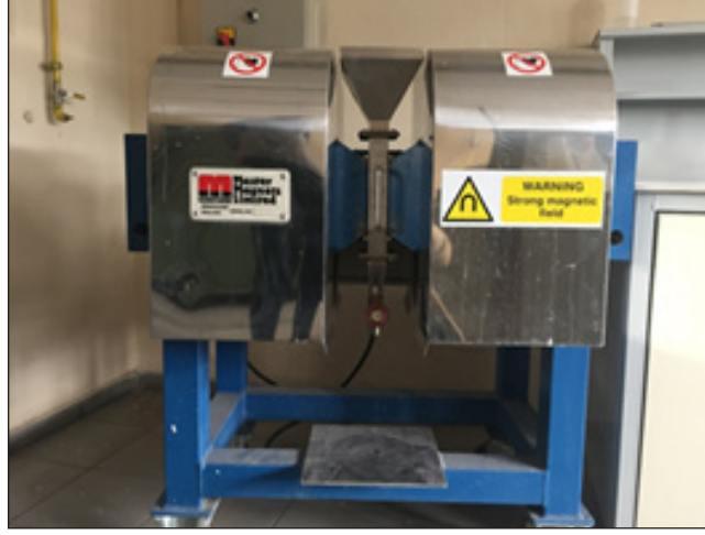
Şekil 10- Laboratuvar tipi yüksek alan şiddetli yaş manyetik ayırıcı.
